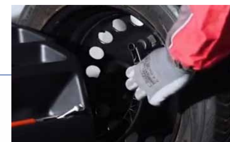
Automatische wieldata ingave d.m.v. inleesarm, tevens selecteert de machine zelf de balanceermodus (alu/staal). Alleen bij een stalen velg moet de velgbreedte handmatig worden ingevoerd, rest gaat via de inleesarm.
