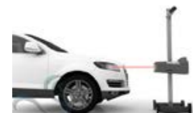
Kruislaser voor exacte bepaling midden koplamp
