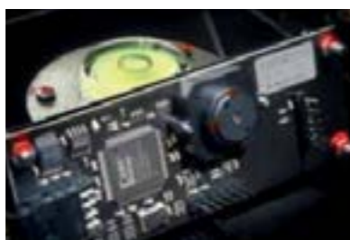
CMOS-camera met hoge resolutie en beeldsnelheid zorgen voor een zeer nauwkeurige meting.
