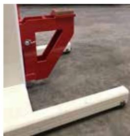
G-adaptor voor het heffen van speciale voertuigen zoals AGV'S, trams en treinen
